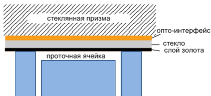
Рис. 6. Схема микрожидкостной проточной ячейки [75].
