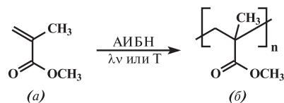
Рис. 2. Реакция свободнорадикальной полимеризации метилметакрилатных мономеров в полиметилметакрилат.
