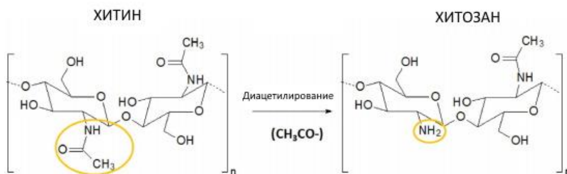
Рисунок 25 – Реакция деацетилирования при переходе хитина в хитозан (Muxika et al., 2017)
