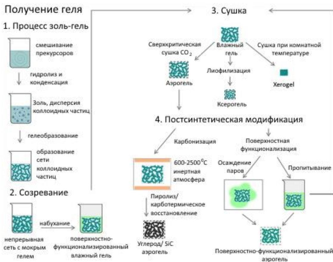
Рисунок 23 – Общая схема процесса получения аэрогелей (Montes and Maleki, 2020)
