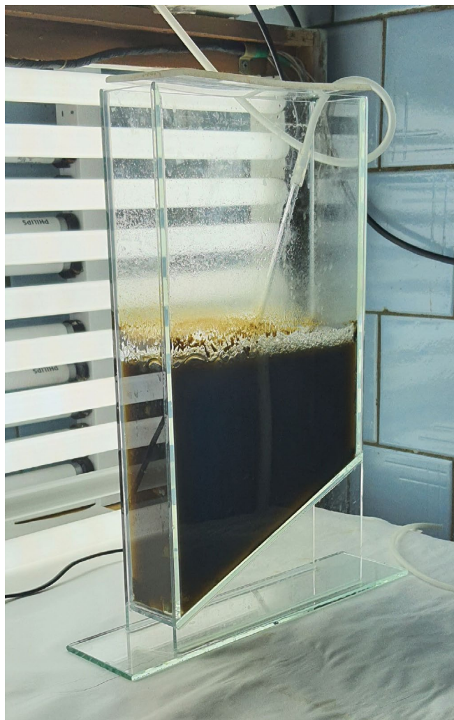
Рис. 1. Лабораторная установка для интенсивного культивирования диатомовой водоросли N. shiloi .
